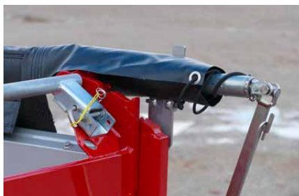
Składana rurka prowadząca zapobiega uszkodzeniom.
