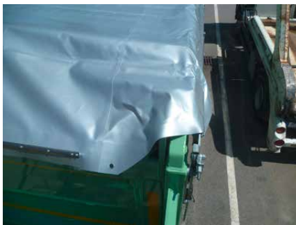
Wywrotka trójstronna: plandeka całkowicie zakrywa łożysko ściany tylnej.
