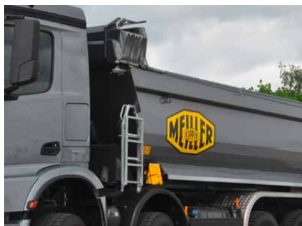
Wywrotka tylnozsypowa: drabinka z uchwytem na wsporniku plandeki.
