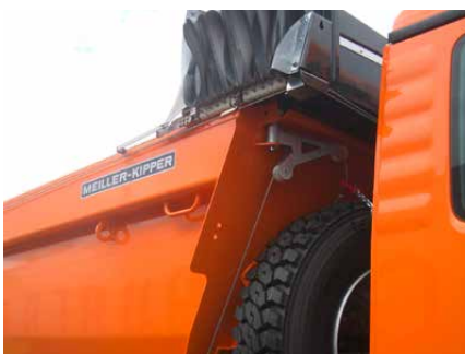
Wywrotka tylnozsypowa: możliwość połączenia z kołem zapasowym na ścianie czołowej.
