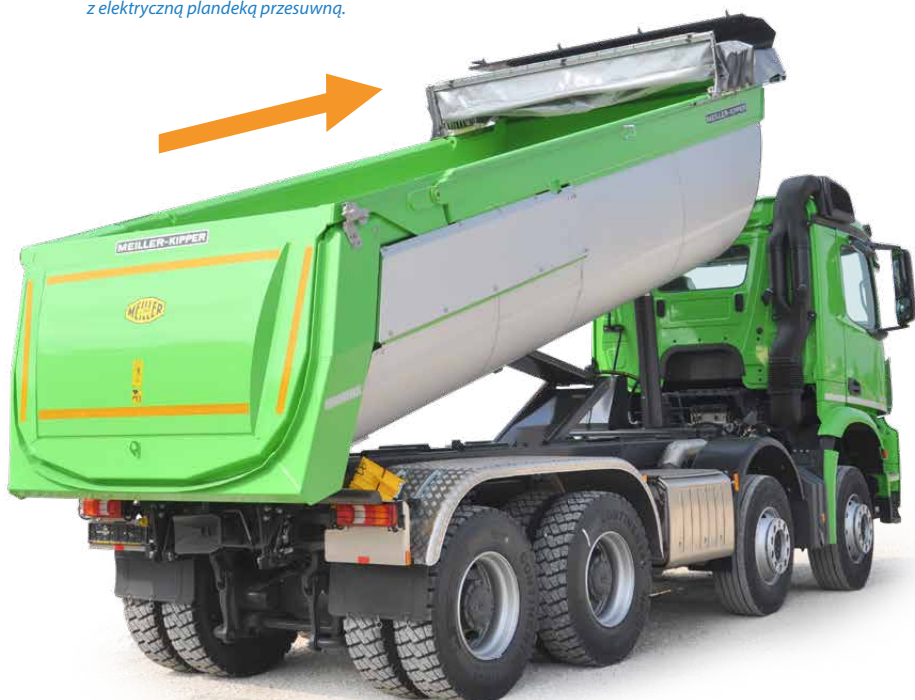
Wywrotka tylnozsypowa MEILLER z elektryczną plandeką przesuwną.
