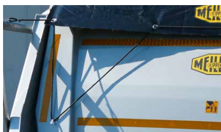
Wywrotka tylnozsypowa: nisko ułożone haki zwiększają komfort naprężania plandeki.
