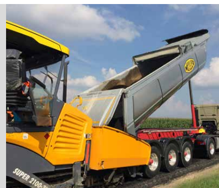
Rozścielacz do nawierzchni: przy zamkniętej plandece asfalt utrzymuje niezbędną temperaturę.
