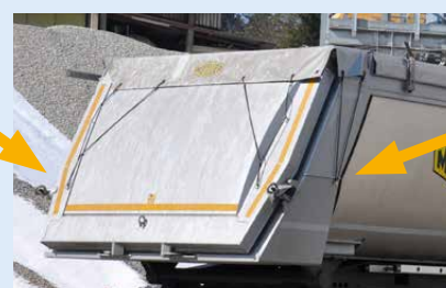
Łatwa obsługa za pomocą regulowanej korby z okalającym uzębieniem.
