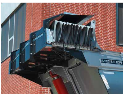
Dach ochronny plandeki zapewnia ochronę przy załadunku
