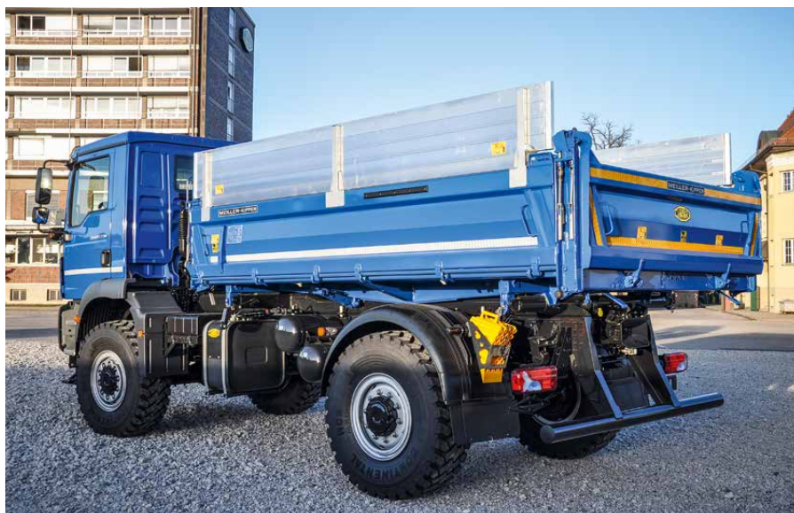
Wywrotka trójstronna MEILLER z pakietem komfortowym i aluminiowymi ścianami nakładanymi.
