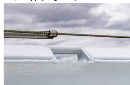
Elastyczne zabezpieczenie ładunku umożliwiają pierścienie do mocowania w burtach (siła mocowania 2 t).
