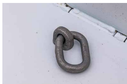
Wtykane pierścienie do mocowania w narożnikach umożliwiają dowolne mocowanie ładunku (siła mocowania 8 t).
