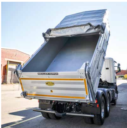
Plandeka przesuwana MEILLER: wydajny system plandek.
