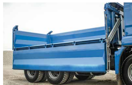
Ściana boczna wychylna i rozkładana z odciążeniem sprężynowym.
