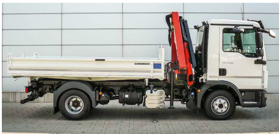
Wywrotka trójstronna MEILLER z żurawiem załadunkowo-wyładowczym
