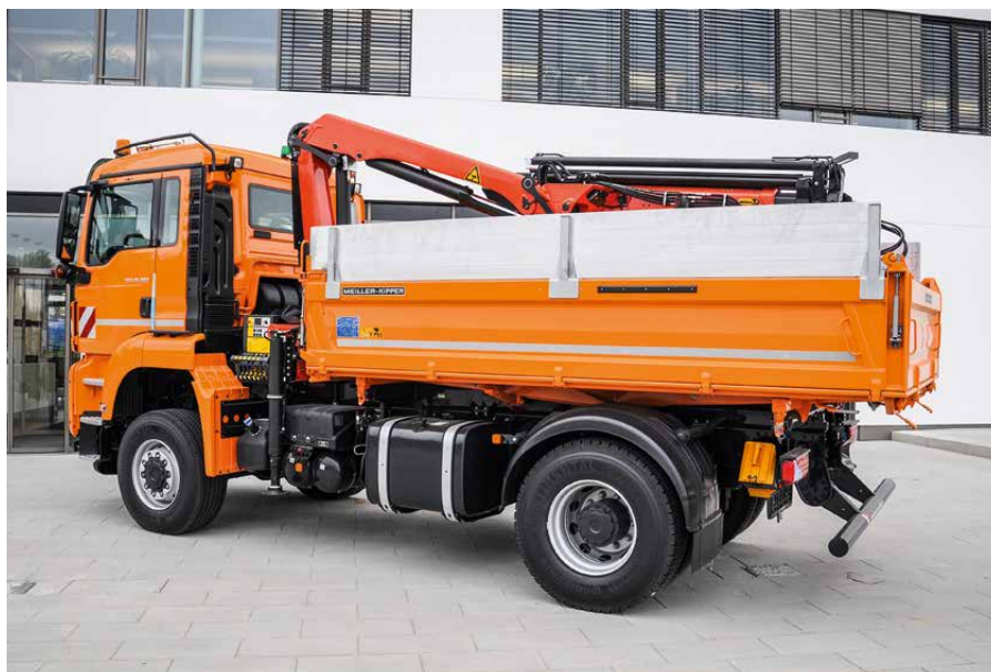
Wywrotka trójstronna MEILLER Typ 9 z przygotowaniem do żurawia ładunkowo-wyładowczego i aluminiowymi ścianami nakładanymi.
