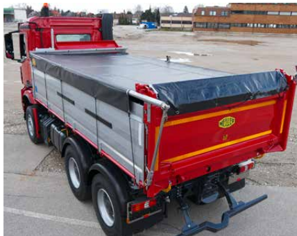
Boczna plandeka rolowana MEILLER obsługiwana od dołu za pomocą korbki.
