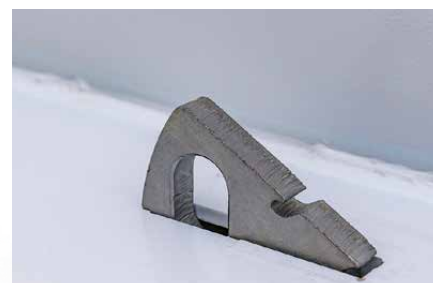
Składane i chowane pierścienie do mocowania w podłodze: żaden sypki materiał nie będzie przywierać (siła mocowania 2 t).
