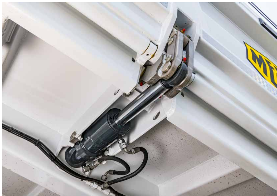
Wydajna hydraulika MEILLER na ścianie bocznej Bordmatik
