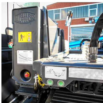
Jednostka sterująca MEILLER ze zintegrowanym wskaźnikiem kontrolnym przeładowania (seryjnie przy wyposażeniu w teleskop)
