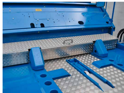
Duża skrzynia-schówek z zamykaną pokrywą, umieszczona w poprzek za ramą burtową.
