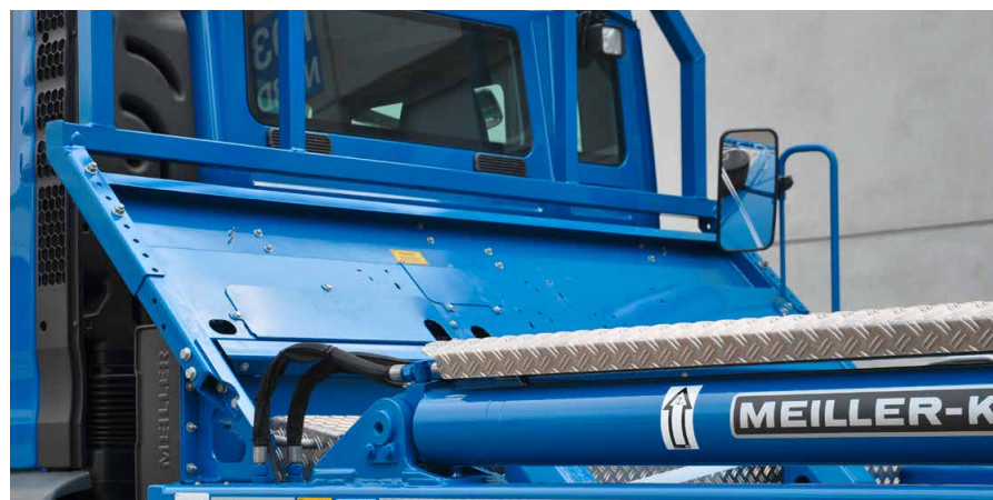
Ochrona kierowcy i kabiny kierowcy: ściana czołowa MEILLER w różnych wersjach wykonania
