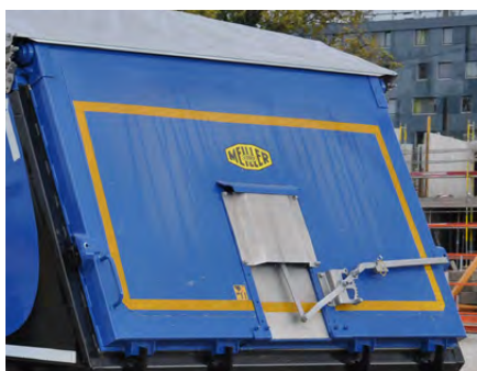
Verrou sécurisé et parfait dosage avec la trappe à grains.
