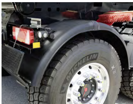
Des supports stables pour les garde-boue sont indispensables lors d'interventions sur des chantiers.
