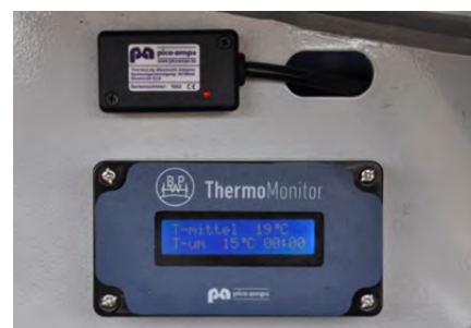
Les mesures sont effectuées toutes les minutes : un protocole de transport surveille la qualité de chaque chargement.
