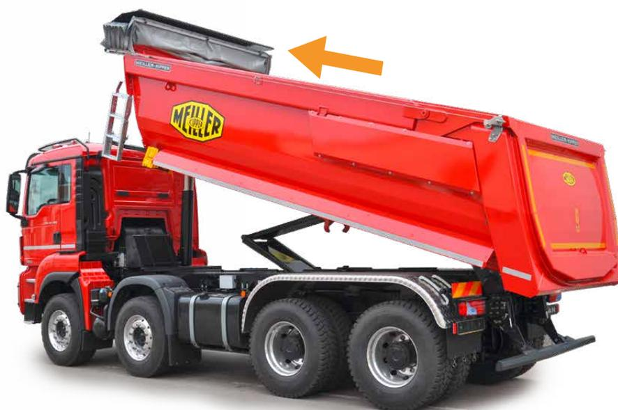
... oder Schiebeplane, ganz einfach mit Funkfernsteuerung zu bedienen.
