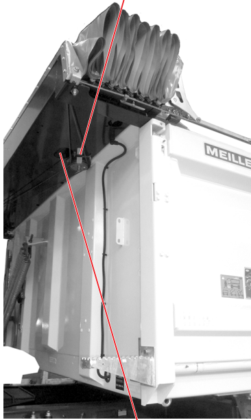
T-Griff (Freilauf Getriebe) für die Notbetätigung des elektrischen Planenantriebs
