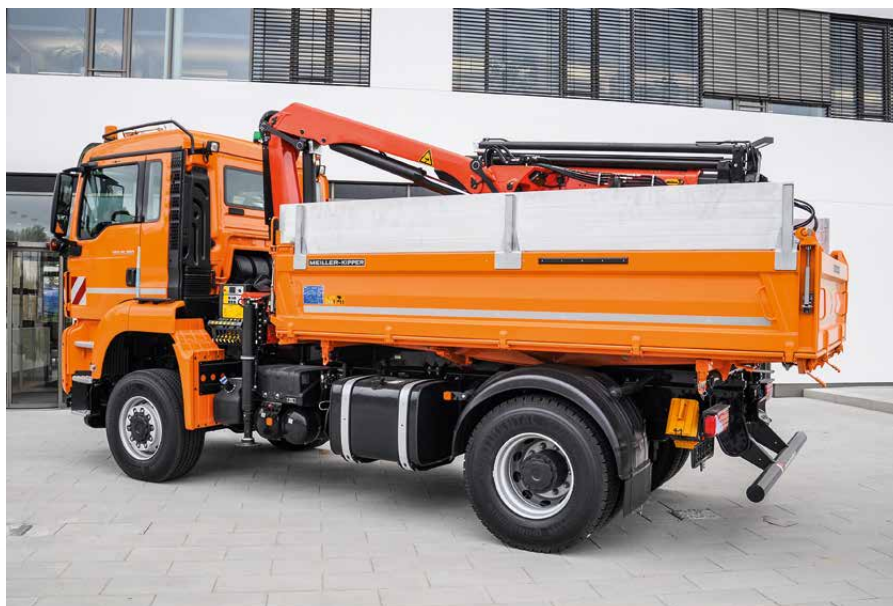
Třístranný sklápěč MEILLER typové řady 9 s nakládacím jeřábem a hliníkovými nástavci bočnic
