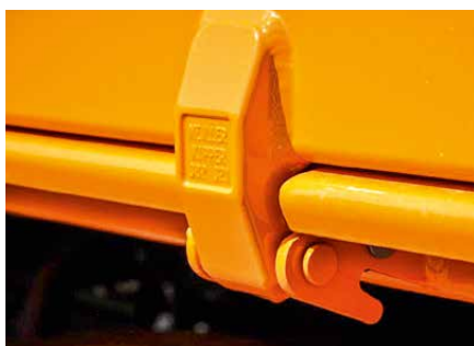
Integrované háky pro plachtu na podlaze sklápěcí korbý
