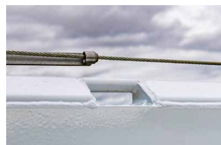
Flexibilní zajištění nákladu je umožněno díky průvlakům pro uchycení popruhů (síla v tahu 2 t).
