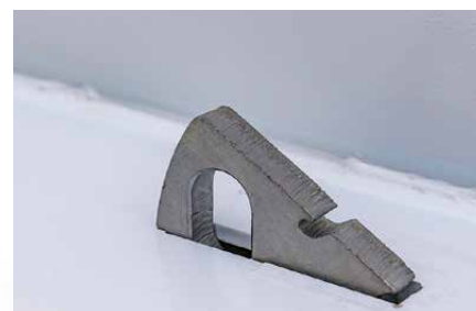
Zapustitelné, sklopné vázací oko v podlaze korby: Žádný sypký materiál se nezachytí (síla v tahu 2 t).
