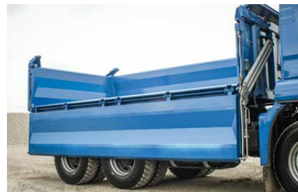
Výkyvná a sklopná bočnice s odlehčením pomocí pružin.
