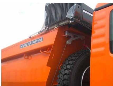
Zadní sklápěč: Lze jej kombinovat s náhradním kolem na čelní stěně.
