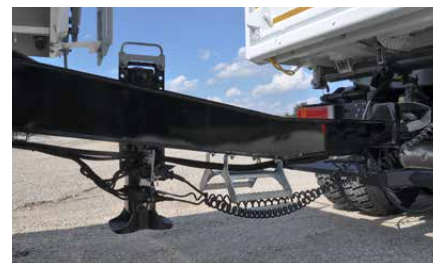
Přesah na oji přívěsu s rukojetí na opěrné patce usnadní otevírání a zavírání boční shrnovací plachty na přívěsu s centrálními nápravami.
