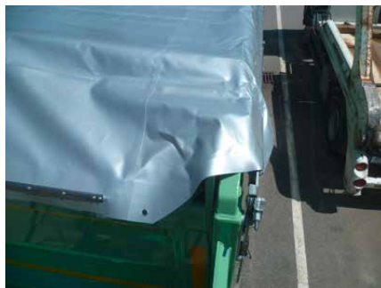
Třístranný sklápěč: Plachta zakrývá celé uložení zadního čela.
